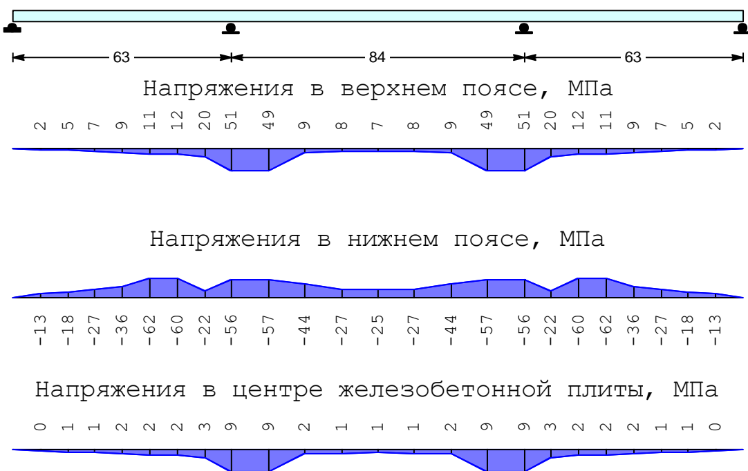
Рисунок 20 – Эпюры напряжений от временных подвижных нагрузок, вызывающих экстремальные значения отрицательных изгибающих моментов
